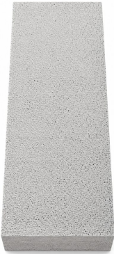
Cấu trúc bọt khí kín phân bố đều trong toàn khối — nguyên nhân khiến khối lượng thể tích thấp mà vẫn chịu nén được.
