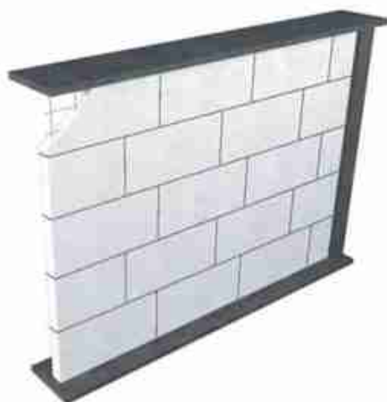
Thi công tẩm EPANEL theo phương ngang
