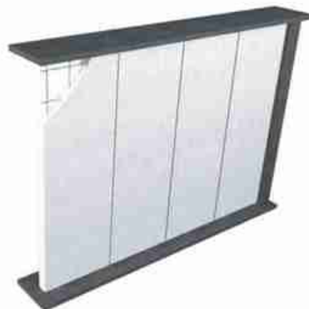
Thi công tẩm EPANEL theo phương đứng
